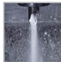
• Si può utilizzare il lubrorefrigerante ad alta pressione attraverso il foro centrale del porta inserto per raggiungere il tagliente.
