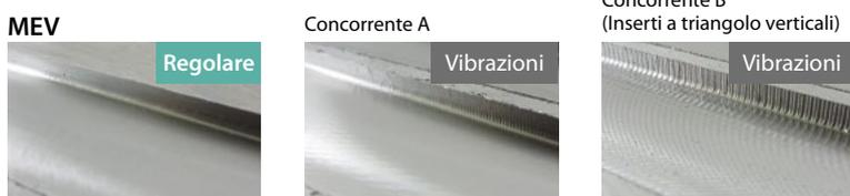
Condizioni di taglio:  $V_c = 220$  m/min,  $ap = 3$  mm (scanalatura),  $fz = 0,10$  mm/dente,  $\phi 20$  (3 inserti), a secco, pezzo: 42CrMo4
